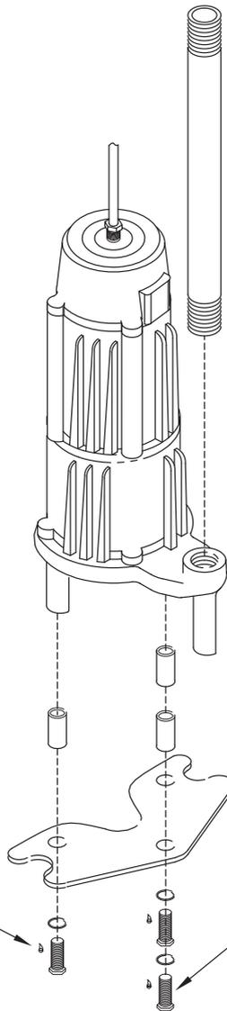
Appliquer le produit d'étanchéité Loctite fourni sur les filetages des boulons
