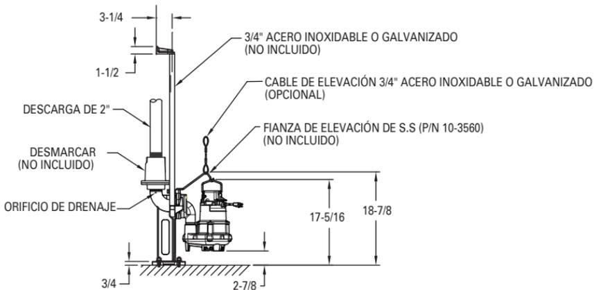
LAS DIMENSIONES SE BASAN EN TAMAÑOS DE CONEXIÓN ANSI ESTÁNDAR. COMPRUEBE SI SE REQUIEREN VÁLVULAS, NO SE MUESTRAN POR CLARIDAD. TODAS LAS DIMENSIONES EN PULGADAS A MENOS QUE SE INDIQUE LO CONTRARIO. EL TAMAÑO MÍNIMO ES SÓLO PARA EL AJUSTE FÍSICO, EL VOLUMEN/FUNCIONAMIENTO DE LA BOMBA PUEDE REQUERIR UN DEPÓSITO MÁS GRANDE.
